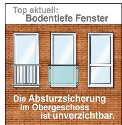
**Bild 1:** Beispiele absturzsichernder Vorrichtungen / Elemente
